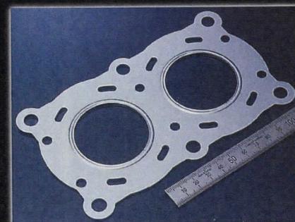
材 質: SUS304H 板 厚: 0.25mm 使用金型: 4種 加工時間: 7分40秒
