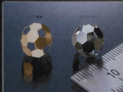
材 質：C-5210H (リン青銅)・SUS304H 板 厚：0.1mm 使用金型：5種 加工時間：4分09秒
