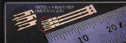
材 質: C-5210H (リン青銅) 板 厚: 0.1mm 使用金型: 6種 加工時間: 1分28秒
