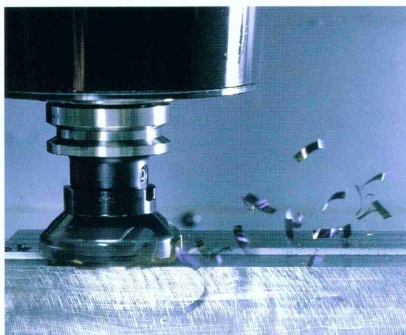
使用工具 : φ60 フェイスミル(刃数6) 切削幅 : 50mm 被削材 : S55C 切削除去量 : 180 cm 3 /min (実績値 : 使用工具等により条件が変わる場合がございます。)
