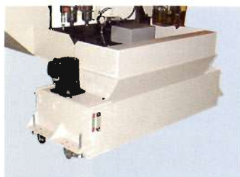
クーラント装置 (タンク部)
