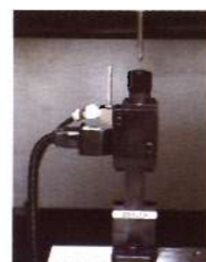
工具長スイッチ (工具長自動測定機能用)
