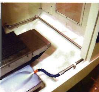
機内洗浄付きクーラント装置 (オイルガン付き)
