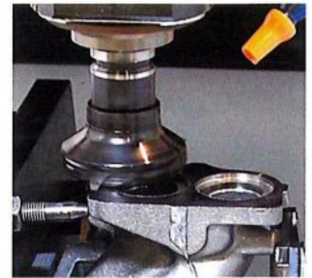
加工ワーク:エグゾーストマニホルド 材質:FCD450
