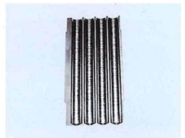
加工: \phi 16 \times 150\text{mm} 材質:SCM420
