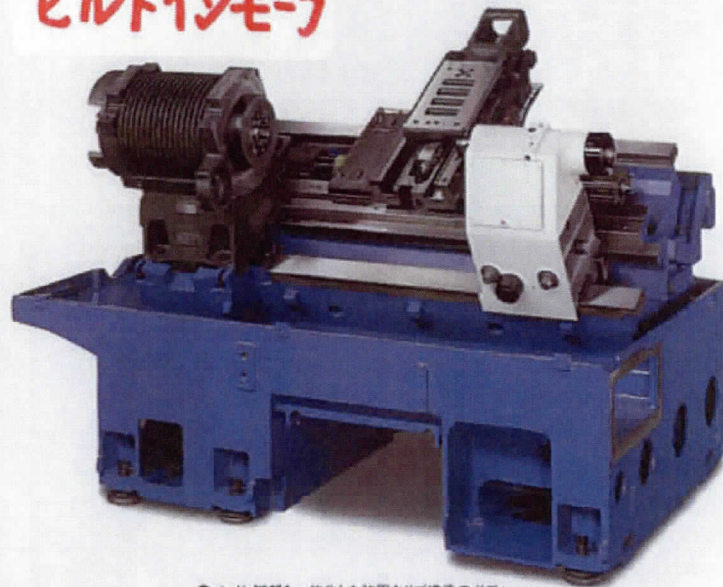
●ベッド・脚部を一体化した強固なリブ構造のボディ。
